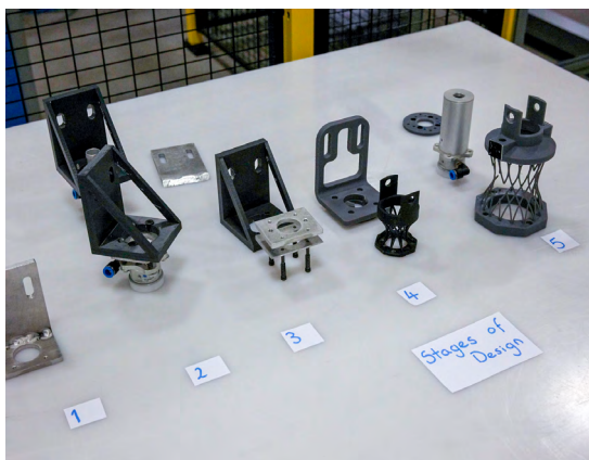
Konsequente Iterationen eines Robotergreifers zum Aufheben und Absetzen, prototypisiert mit Formlabs-SLA-Druckern.
